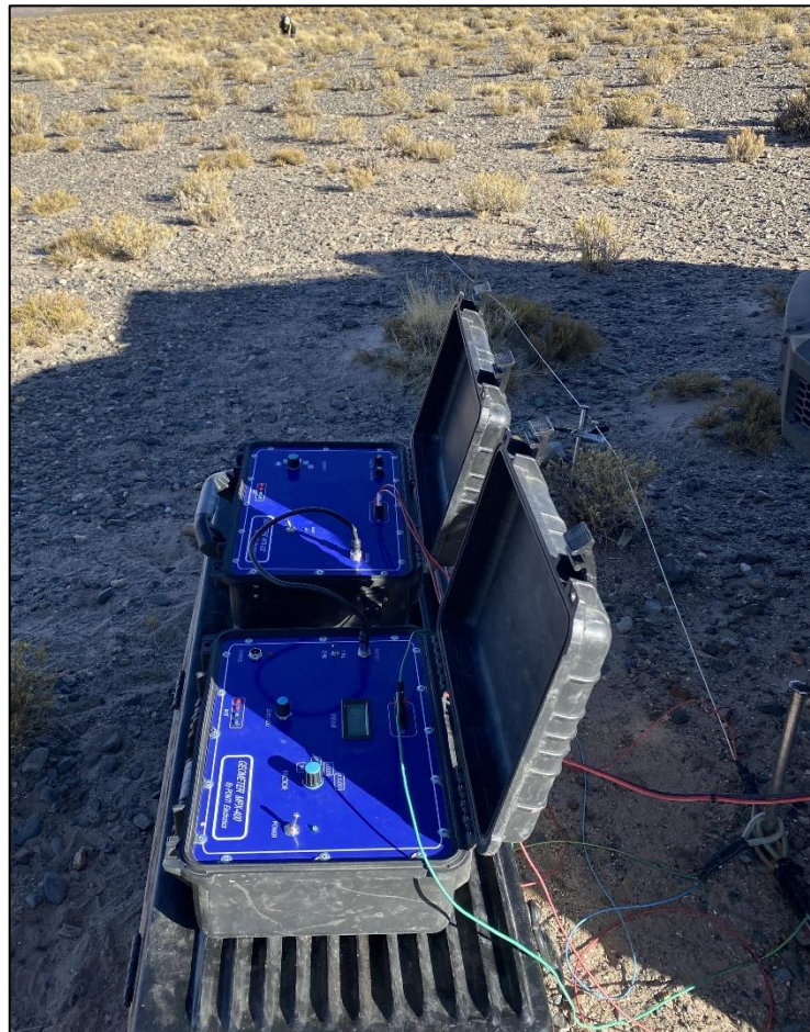
Figura 5: Equipo GEOMETER MPX 400 utilizado para la ejecución de los sondeos.
